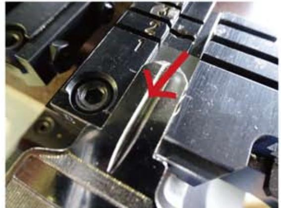
純正キー・ブランクキーが浮かないように鍵足←部分を指で押さえながらバイスにセットします。
