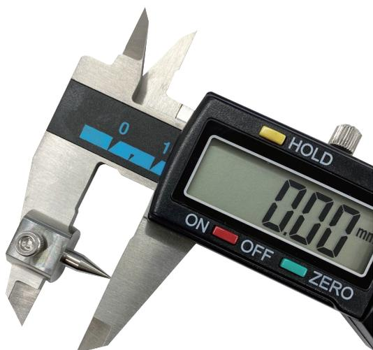
先端を接触させて ZERO セット
